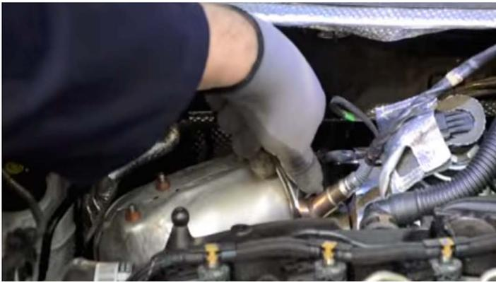
**2. Insertar la cánula y pulverizar por el agujero la mitad de la dosis del limpiador del Filtro de Partículas en dirección a la salida de los gases de escape.**
